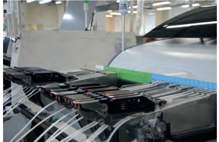
Комплект питателей на штатной подкатной тележке Fuji, доработанной нанесением позиций аналогично маркировке позиций сборочного автомата
